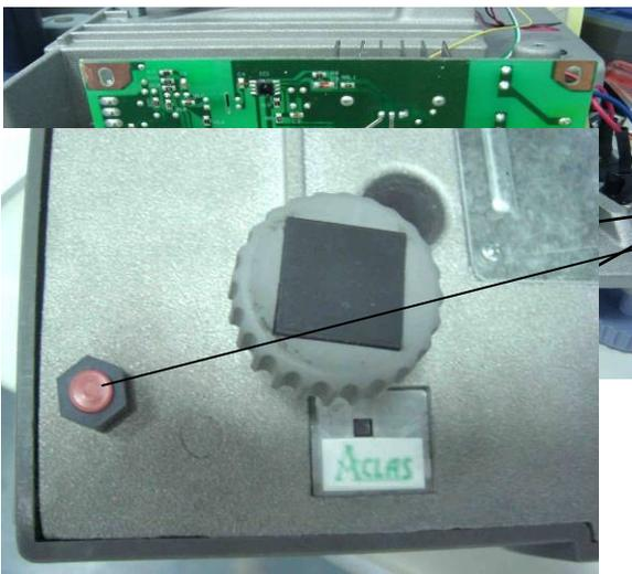
Por favor, haga el sellado después de reemplazar las partes relacionadas en el básico de la precisión de pesaje
