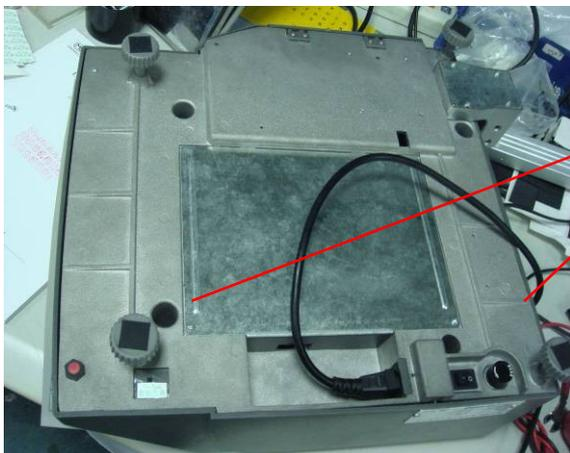
Dé la vuelta a la báscula, retire los dos tornillos y abra la tapa.
