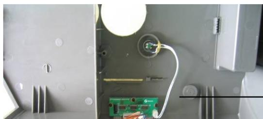
Retire el cable de conexión, y los tres tornillos de la tarjeta
