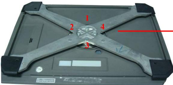
Reitre la bandeja, retire los 4 tornillos de la araña y retire la araña
